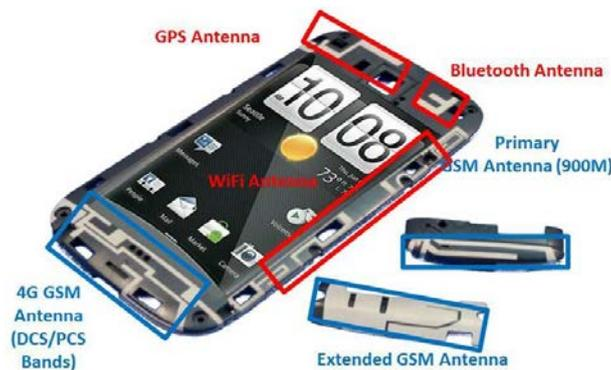
Figure I. 1. Antennes intégrées dans un smartphone [1]
