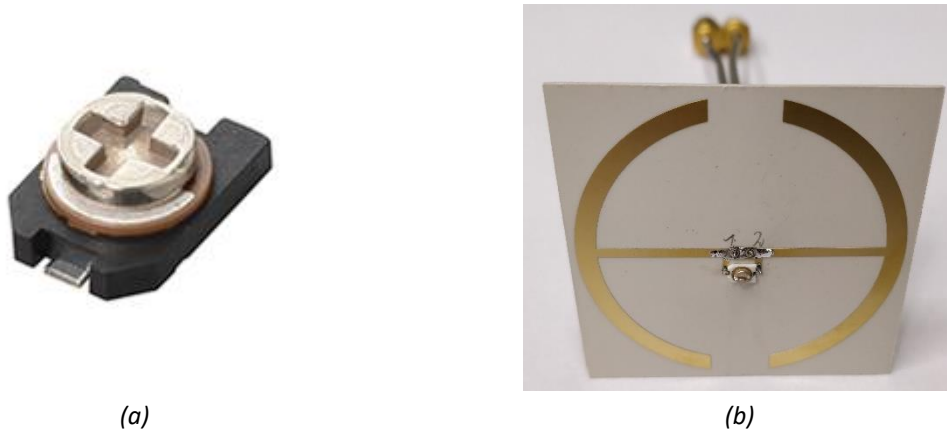
Figure IV. 49. Photos (a) de la capacité ajustable et (b) de l'antenne NFRP assemblée
