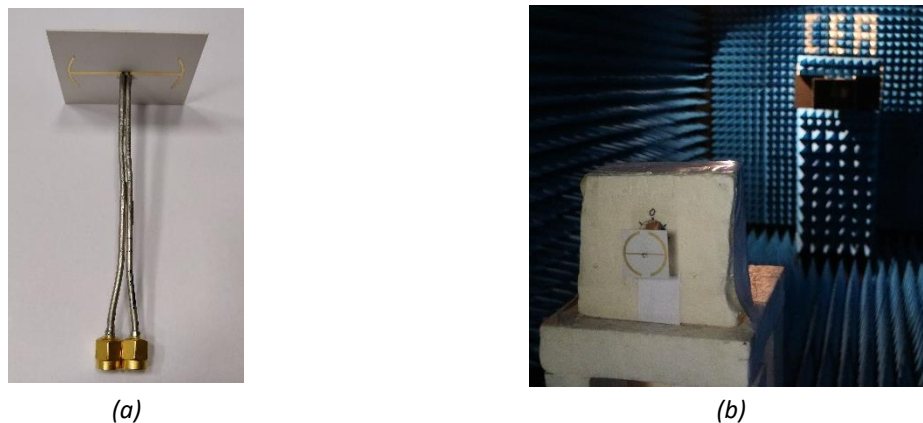
Figure I. 45. (a) Prototype de l'antenne NFRP proposée (b) Configuration du banc de mesure dans la chambre anéchoïde.
