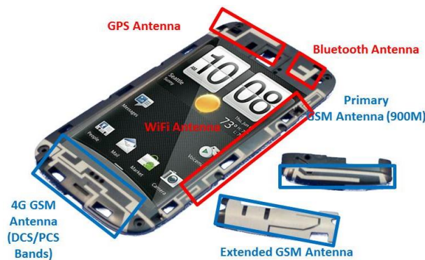
Figure I. 1. Antennes intégrées dans un smartphone [1]
