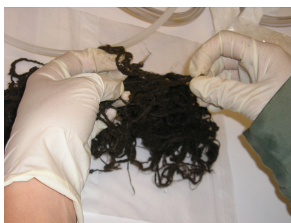
Figure 1.5 : Fibre-Mn en train d'être effilochée (gauche) et échantillon d'eau passant par gravité sur une fibre-Mn contenue dans une cartouche PVC (droite).
