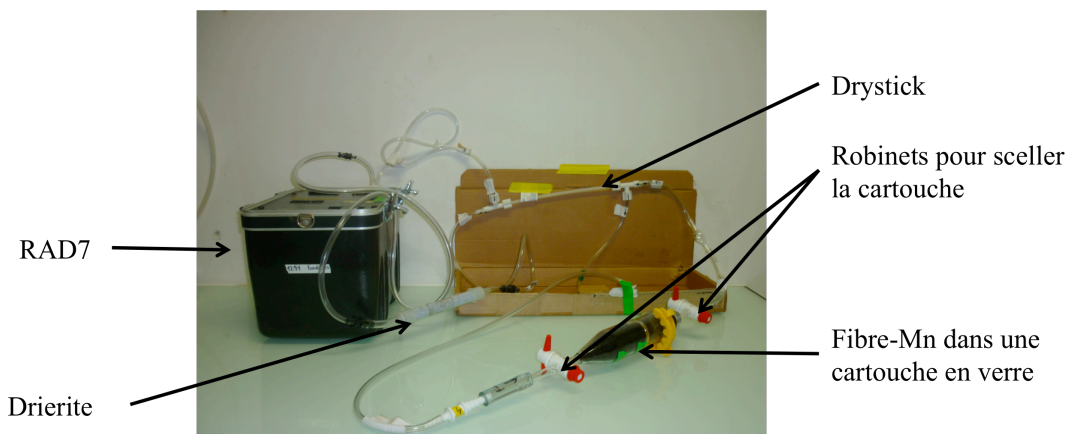
Figure 1.24 : Photo du système pour déterminer les activités ^{224}\text{Ra} et/ou ^{226}\text{Ra} dans une fibre-Mn avec un RAD7.
