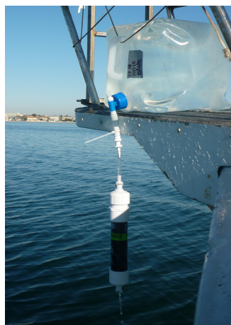
Figure 1.5 : Fibre-Mn en train d'être effilochée (gauche) et échantillon d'eau passant par gravité sur une fibre-Mn contenue dans une cartouche PVC (droite).
