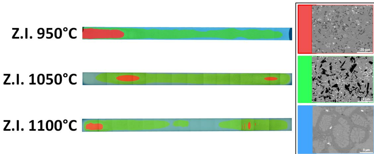
Figure 5-22 : Cartographies de l'interface revêtement substrat suite à la préparation des éprouvettes de type Z.I.
