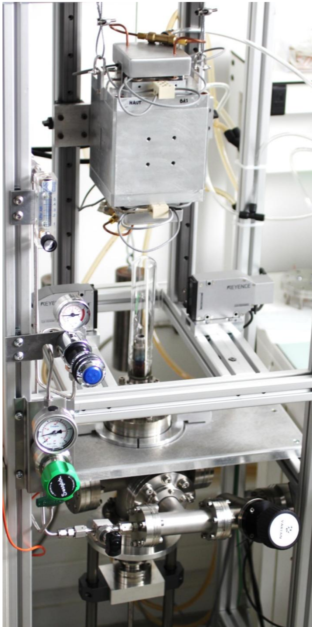
Figure 3-19 : Vue d'ensemble de la machine de fluage poids mort externe
