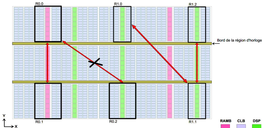
Figure 2.6 : Les différents aspects de la mise en œuvre de la technique de relocalisation de bitstream.
