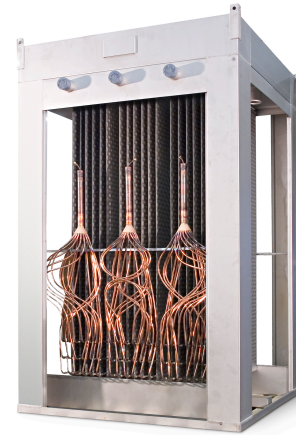
(b) Les équipements récents comprennent des systèmes frigorifiques performants. Ici le fluide frigorigène passe à l'intérieur des plaques alors que le liquide à refroidir ruisselle à l'extérieur de celles-ci ( http://www.omegathermoproducts.nl/ ).
