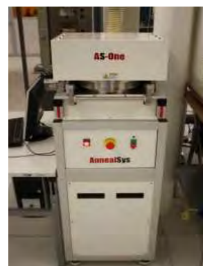
Fig. II.3.67 Fours de recuit métallisation: a) Jipelec Fav4 b) Jipelec JetFirst-JetStar c) Annealsys AS-One.
