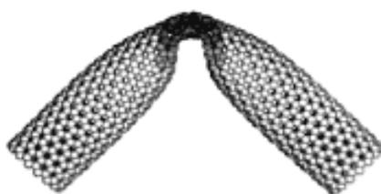
*Figure I-8: Propriétés d'élasticité du NTCs hors du commun : une très grande élasticité (module d'élasticité > 1000 GPa) et une très grande flexibilité (crack stress : 45 GPa)*
