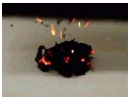
Figure I-11- Réaction explosive des SWCNTs dès leur exposition à la lumière du flash. Photo obtenue dans notre groupe [Pa-1]
