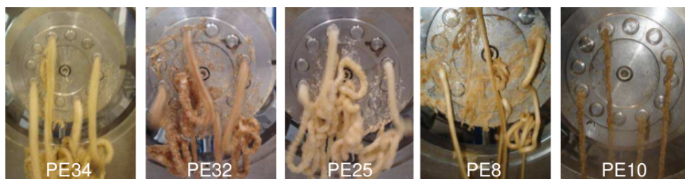
FIGURE 3.12 – Sortie de filière lors de l’extrusion de mélanges formulés Farine de blé/PLA.
