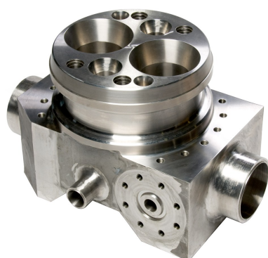
FIGURE 9.2 – Exemple de pièces métallique réalisée en HIP (gauche) et presse HIP grande capacité (droite).
