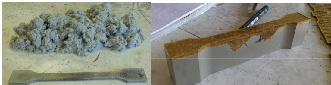
FIGURE 5.15 – Exemples de problèmes de répartition de matière (gauche) et de bavure (droite).
