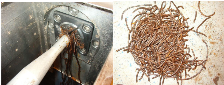
FIGURE 3.5 – Sortie de filière et joncs extrudés de tabac Virginia.
