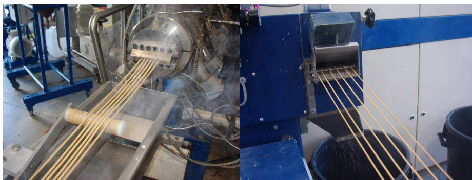
FIGURE 5.4 – Exemple de granulation plasturgique de mélanges farine de blé/PLA. A gauche la sortie de filière, à droite l'entrée du couteau granulateur.
