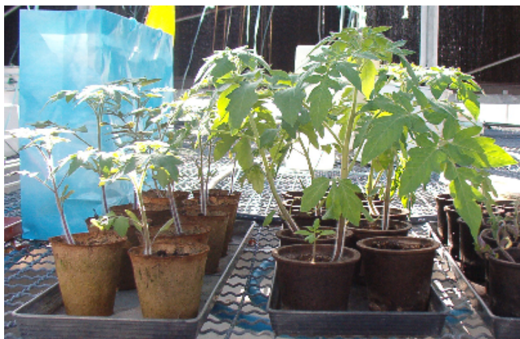
FIGURE 6.11 – Photographie d'un essai de culture de plants de tomates dans un pot de repiquage en tourbe (gauche) et en tourteau de tournesol traité thermiquement (droite).
