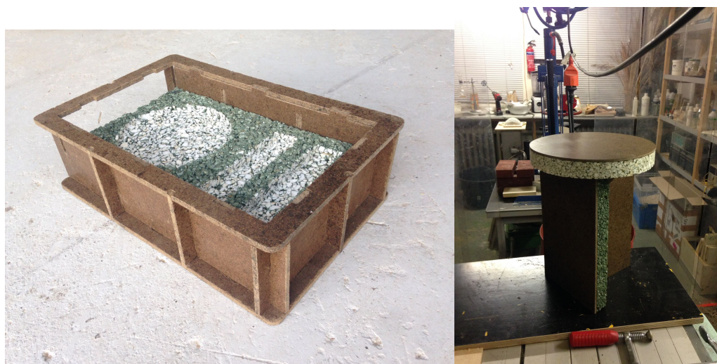
FIGURE 8.1 – Caisse (gauche) et tabouret (droite) 100% tournesol en plaques de tourteau de plante entière et moelle liée avec une colle protéique.
