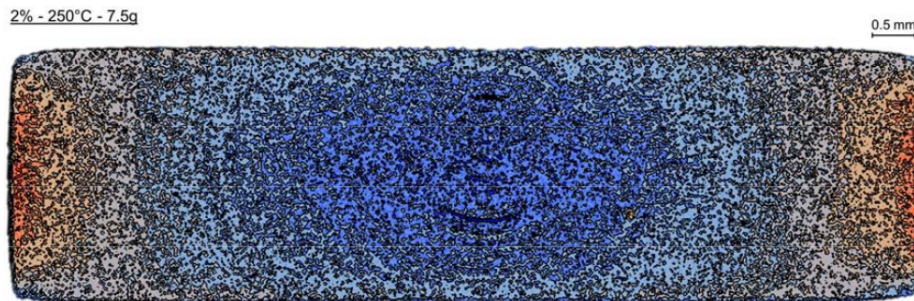
FIGURE 5.19 – Section reconstituée par tomographie X d'un échantillon d' \alpha -cellulose thermocompressée à 2% et 250°C.
