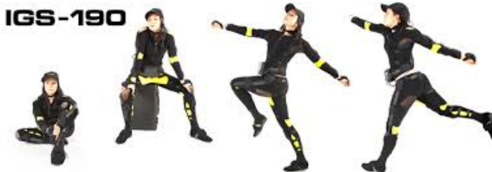
FIGURE 2.2 – L'Animazoo IGS-190 contient dix-huit gyros pour la reconnaissance de geste en plus des marqueurs visuels en jaune.
