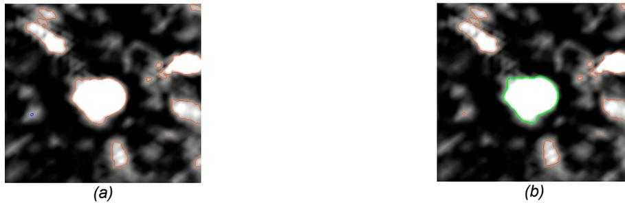
Figure 6.3 – Detection des contours de l'image par la méthode d'iso-contours.
