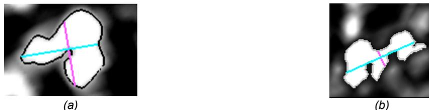
Figure 7.5 – Calcul des diamètres maximal et minimal des contours à forme très irrégulière. Dans ces cas, les rayons peuvent intersecter plusieurs fois le contour.
