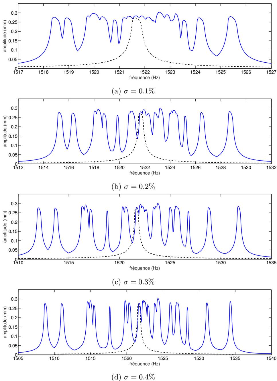
FIGURE IV.10 – Réponse forcée pour différents taux de désaccordage aléatoire  $\sigma$  (désaccordée —, accordée - - -)
