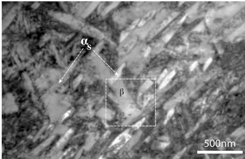
Figure 53. Micrographie présentant une vue à relativement faible grossissement de la zone étudiée (alliage Ti 5553).
