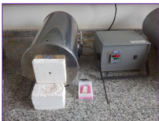
Figure II-8 : Gauche) four tubulaire de recuit ; Droite) porte échantillon pour le polissage
