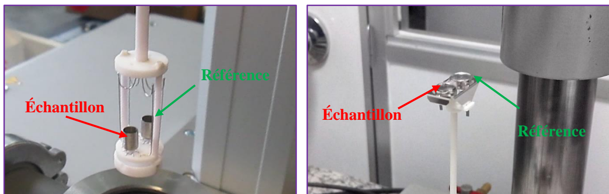
Figure II-9 : Canne d'analyse ATD ; Gauche) Sétaram 96 Line Evo (IPG Paris) . Droite) NETZSCH DSC 404 cell (LAMAV, São-Carlos).
