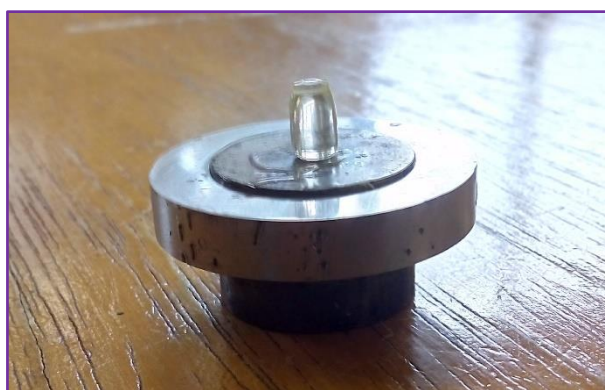
Figure II-8 : Gauche) four tubulaire de recuit ; Droite) porte échantillon pour le polissage
