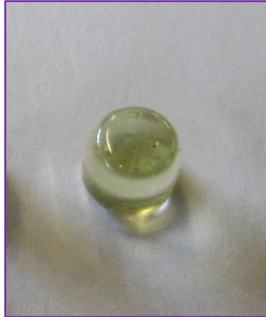
Figure V-14 : photo de la déformation du verre PC60.20 après 35 minutes de recuit à 755°C. La forme de départ est un cylindre droit.
