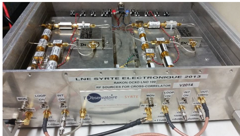
FIGURE IV.7 – Photographie du système générant les signaux d'horloges du digitaliseur hétérodyne.
