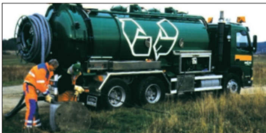
Figure 4.29 : Camion-citerne de transport d'urine.
