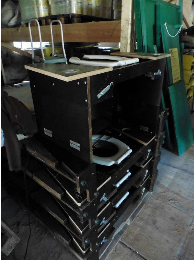
Photo 4: Prototypé d'un modèle de toilettes sèches pliables et qui se juxtaposent les unes sur les autres pour faciliter le transport.
