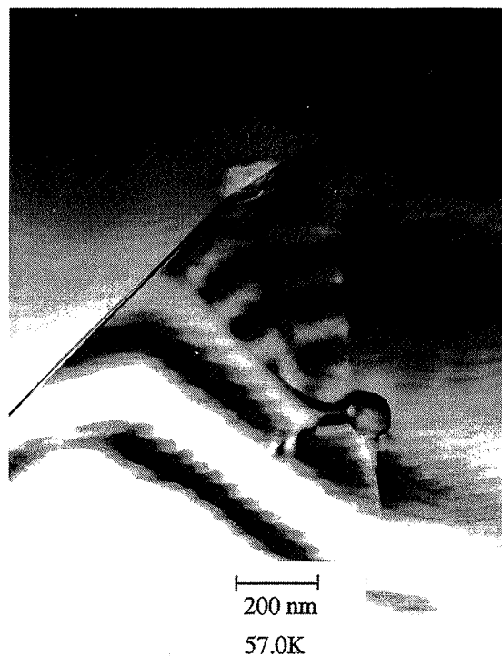
Figure II-22 : précipité de TiB_2 d'environ 100 nm entouré de dislocations.
