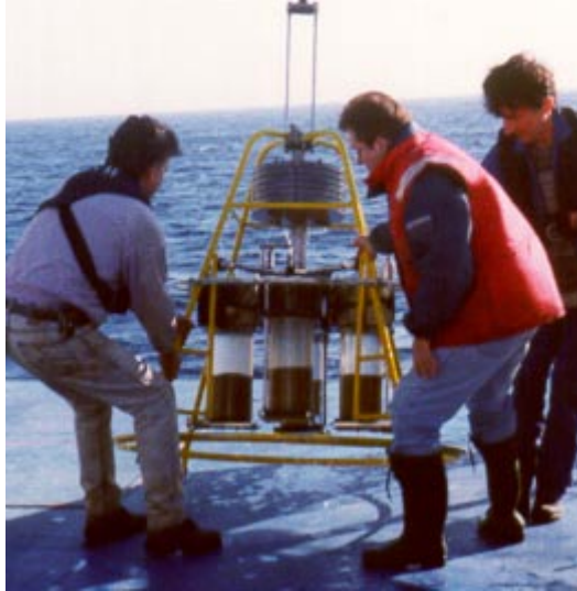
Figure II.15: Photo du carottier Minicorer Mark VI utilisé lors des campagnes SOFi pour les prélèvements de sédiments.
