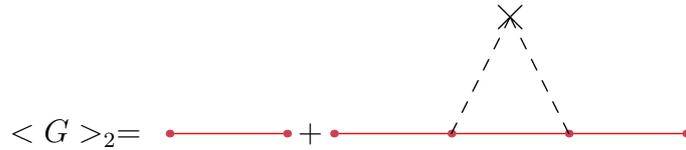
FIGURE D.1 – Représentation en diagrammes de Feynman de  $\langle G \rangle_2$  avec le propagateur libre  $G_0$  (le trait rouge reliant deux points) et l'interaction avec le désordre  $G_0 \langle V G_0 V \rangle G_0$ .
