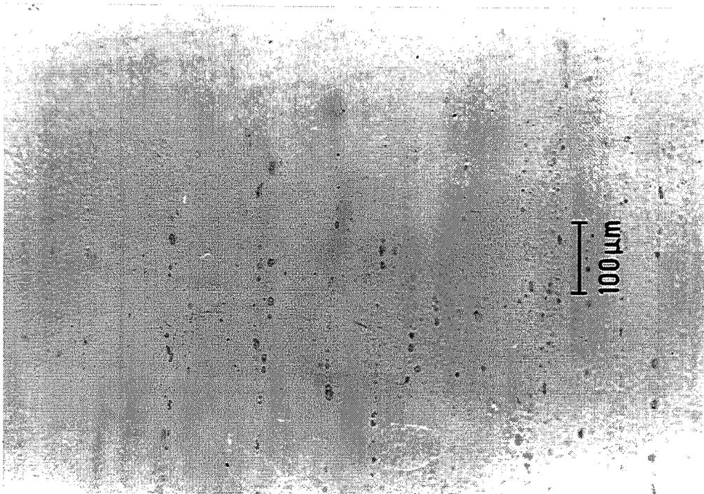
Figure III.40 : alliage traité TTB -  $\frac{\Delta \epsilon_p}{2} = 4 \times 10^{-3}$ , 20°C
