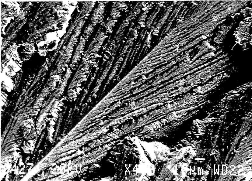
Figure 3.10 : Faciès en arête de poisson. Monocristal d'orientation  $\langle 100 \rangle$ .
