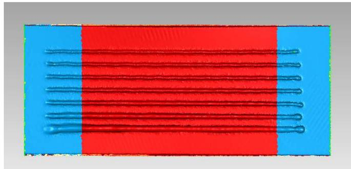
Figure 2.16 : Sélection de la zone retenue pour la caractérisation géométrique des cordons
