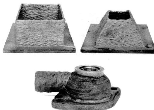
*Figure 1.29 : Pièces fabriquées en MIG à l'aide d'un robot de soudage [53]*
