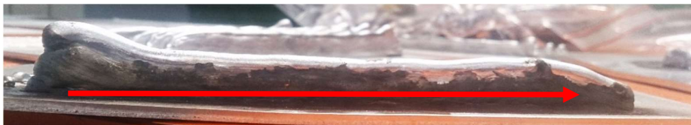
Figure 5.2: Amplification des défauts géométriques en début et en fin de cordon lors de la superposition de cordons réalisés en conservant pour chaque cordon le même sens de dépôt, donné par le sens de la flèche
