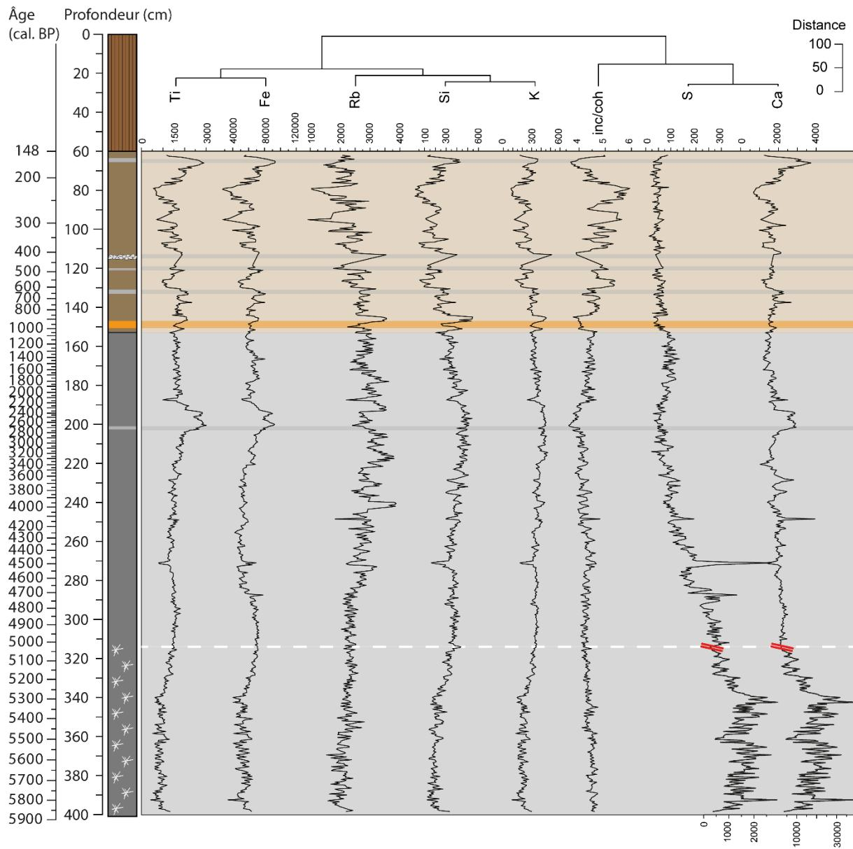
*Figure 22 : Courbes des variations relatives (en intensité) des éléments majeurs mesurés par XRF Core Scanner et du rapport incohérent/cohérent (inc/coh) face au profil composite CAN-4 (légende Figure 20). Une analyse d'agglomération a été réalisée pour regrouper les variables étudiées en fonction de leur similarité.*
