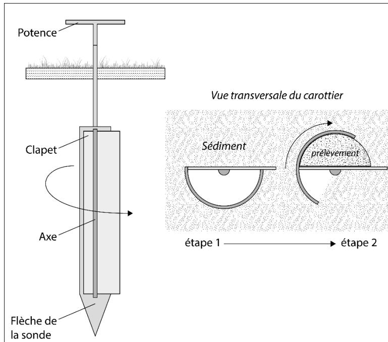
Figure I- 1 : Schéma de fonctionnement du carottier russe.
