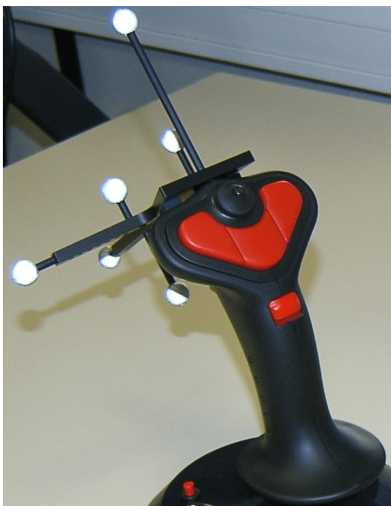
FIGURE 3.12 – Le flystick équipé de marqueurs, repérable dans l'espace grâce à sa signature.
