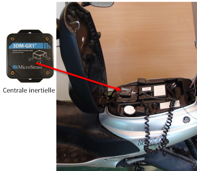
FIGURE 5.4 – Positionnement de la centrale inertielle
