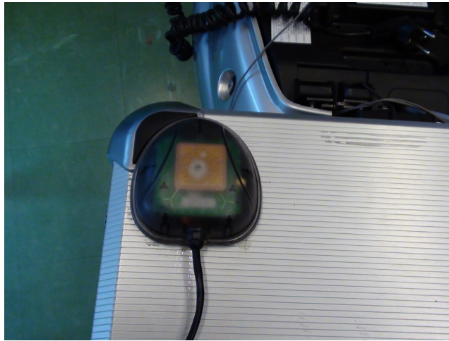
FIGURE 5.6 – Positionnement du GPS Hi-204E
