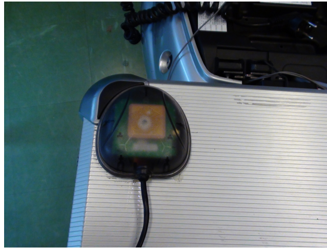
FIGURE 5.6 – Positionnement du GPS Hi-204E
