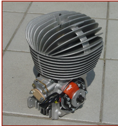
Figure 7 : les ailettes de ce moteur à explosion participent tant à la résistance mécanique du moteur qu'à son refroidissement
