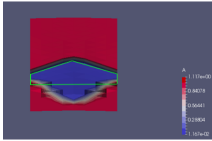
FIGURE 6.6 : Saturation en eau, uniquement modèle PC_a et méthode de shift
