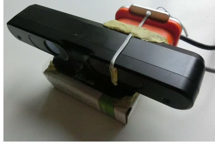
FIGURE 3.11 – Le couple de capteurs Xtion Pro Live - MTi
