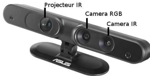
FIGURE 3.3 – La caméra couleur et profondeur Xtion Pro Live d’ ASUS
