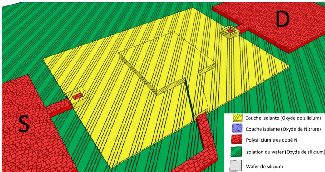
Figure 3-16 : Ouverture des contacts de source et de drain
