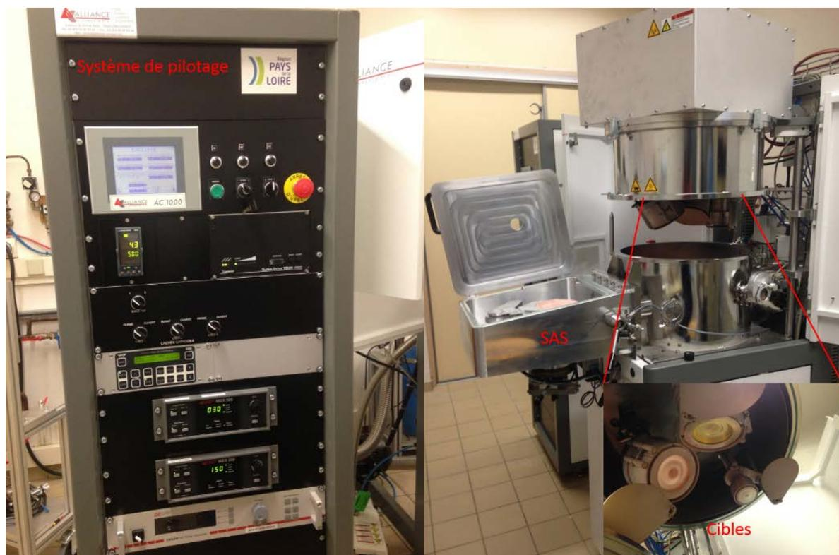
Figure 2-4 : Photo d'un réacteur utilisé pour le dépôt de couche mince cuivre/carbone
