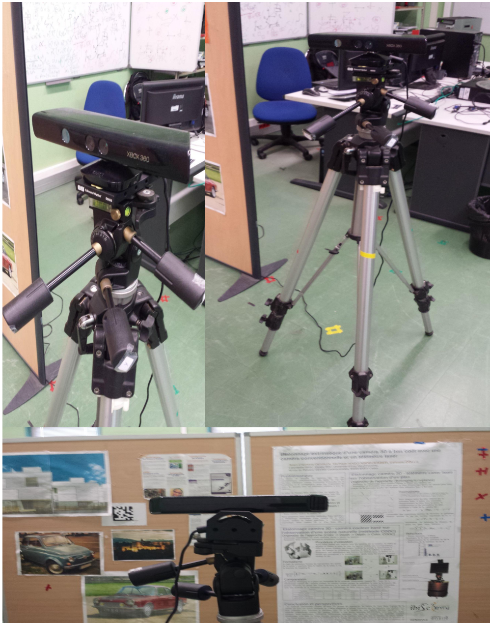
FIGURE 4.12 – Dispositif expérimental pour l'évaluation des rotations estimées par notre système.
