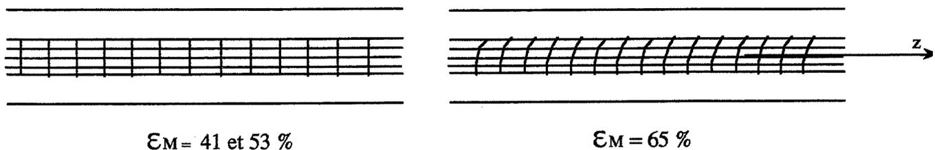
Rappelons toutefois que le barreau martelé à 65% a été préchauffé à 260°C et que la température joue un rôle sur l'écoulement plastique de la matière.
