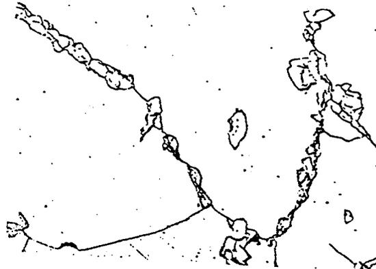
Figure III.13 : Germination des grains D.I.R. le long des joints de grains de la microstructure initiale du solvant [Chongmo-Hillert 1981]
