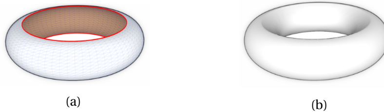
FIGURE 2.7 – Un exemple sur les composantes de bord et les trous sur un maillage (a) le trou dans le tore est délimité par deux anneaux représentant les bords (en rouge). (b) Le trou est rempli en obtenant un tore avec une topologie en anneau.
