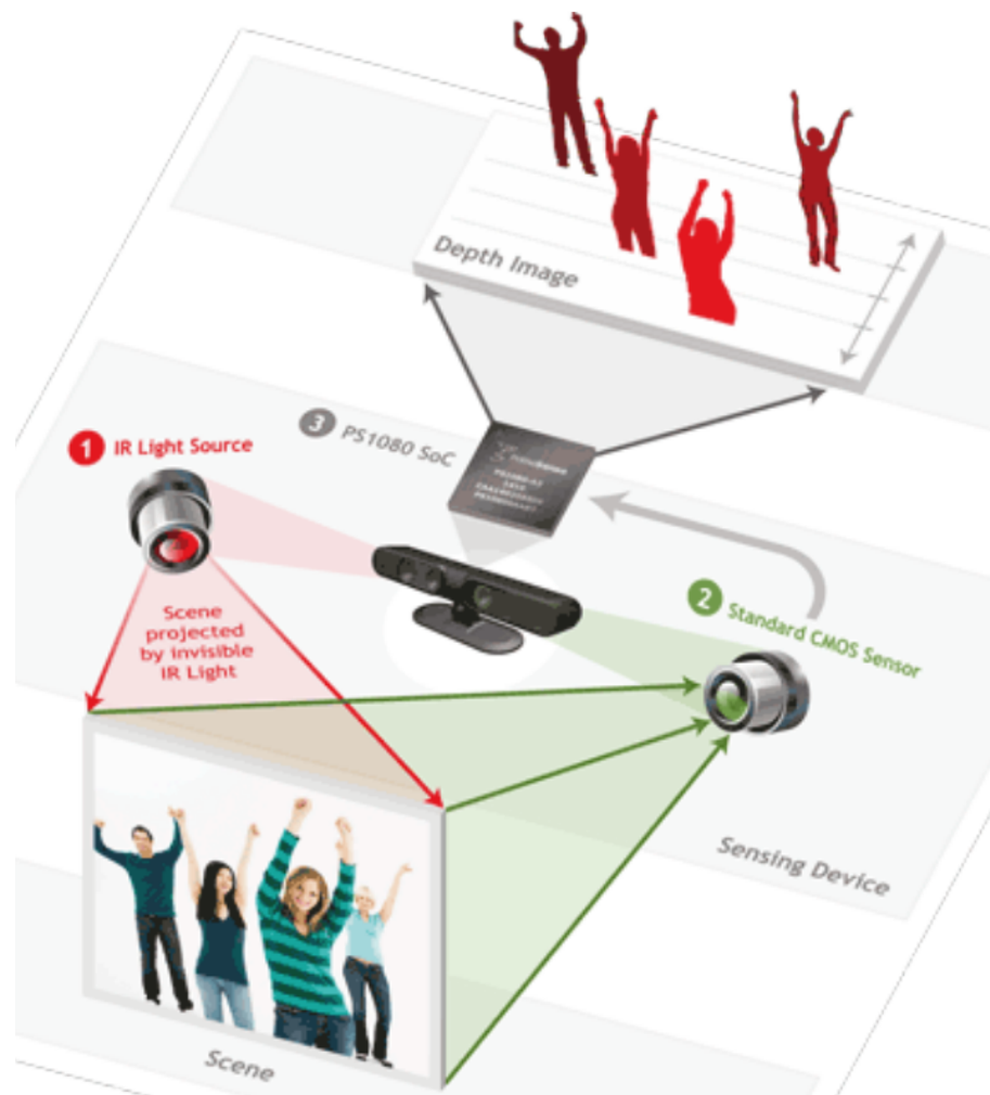
FIGURE 1.2 – Schéma de fonctionnement de la caméra 3D (source : PrimeSense.com).
