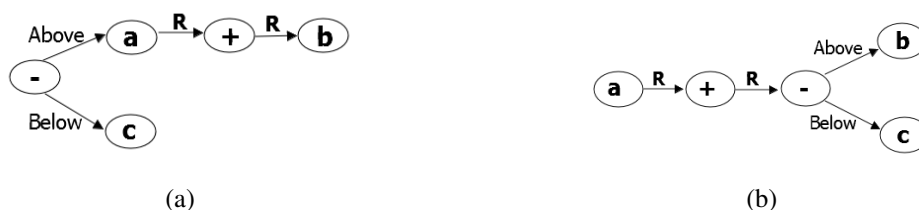
Figure 8.1 – L'arbre des relations entre symboles (SRT) pour (a) \frac{a+b}{c} et (b) a + \frac{b}{c} , 'R' définit une relation à droite.
