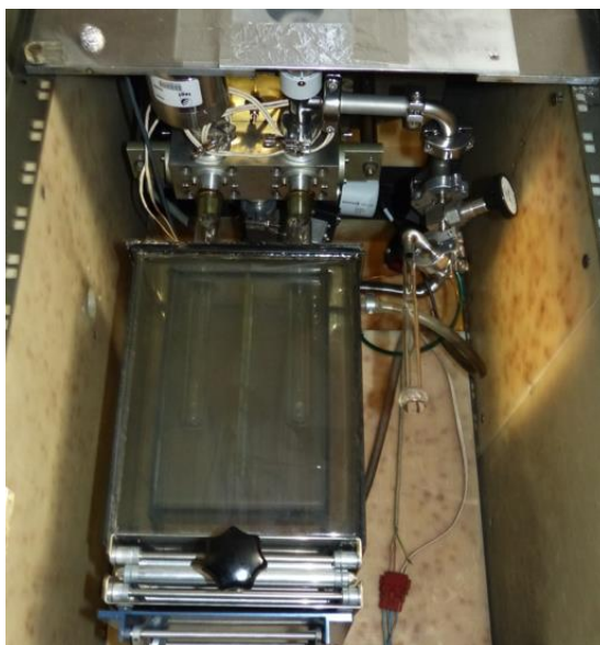
Figure V-14. Photographie de la microbalance et du bain-marie, à l'intérieur duquel on aperçoit les deux tubes, avec à droite l'échantillon, et à gauche, la référence
