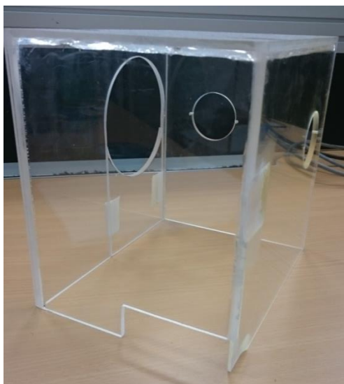
Figure IV-18. Enceinte utilisée pour assurer le contrôle de l'humidité relative durant les expériences de radiolyse pulsée
