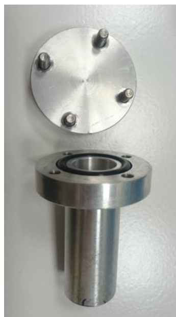
Figure II-11. Réacteur en aluminium utilisé pour l'irradiation des pastilles
