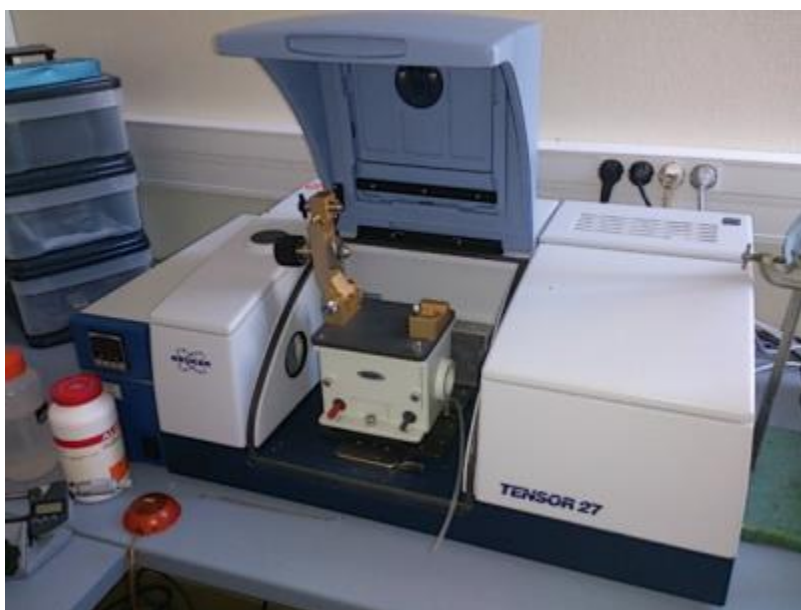
Figure II-14. Spectromètre infrarouge FT-IR Tensor 27 de Bruker équipé avec l'accessoire ATR Golden Gate
