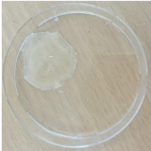
Figure IV-17. Film de montmorillonite d'Arizona utilisé pour les expériences de radiolyse pulsée
