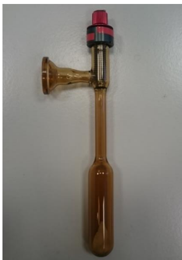
Figure II-9. Ampoule d'irradiation permettant le conditionnement de l'échantillon, son irradiation puis l'étude de la quantité de dihydrogène formé
