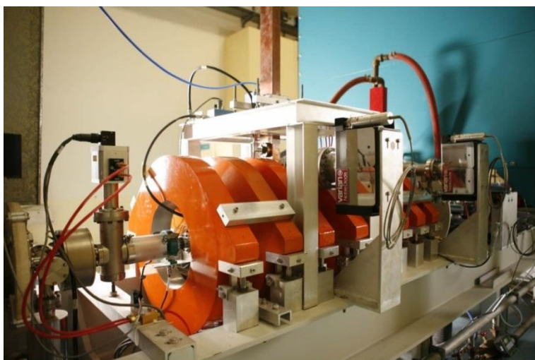
Figure II-1. L'accélérateur linéaire d'électrons ALIENOR
