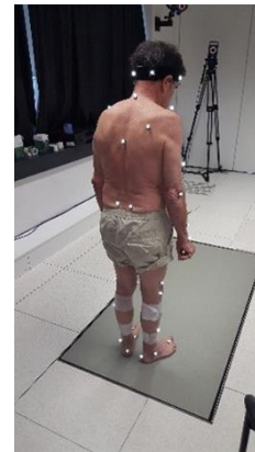
Figure 7 : Exemple de système Vicon (optique avec marqueurs) 5
