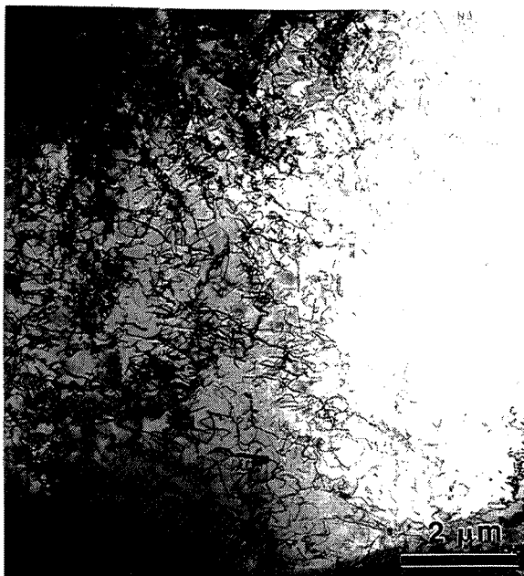
Planche 18 : Dislocations observées en MET dans Fe-40Al-200B recuit 170 heures à 400°C.
