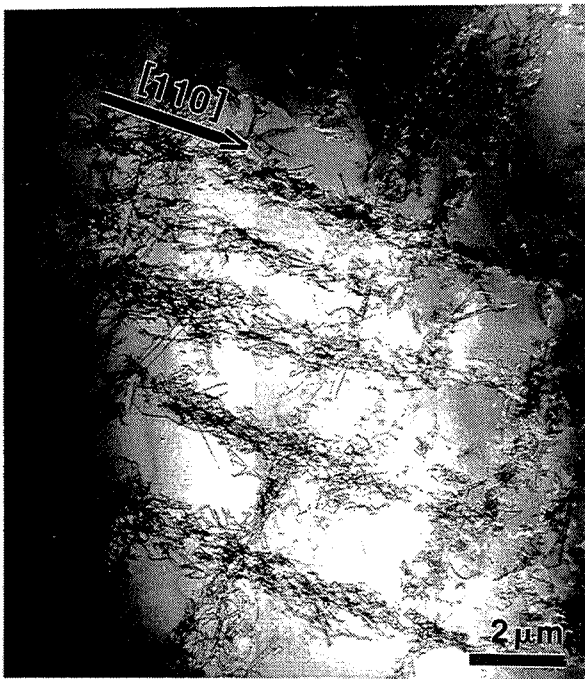
Planche 16 : Dislocations observées en MET dans Fe-40Al-200B trempé.
