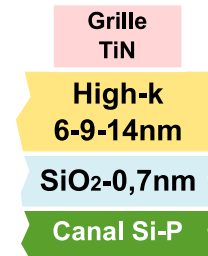
FIG. 3.22: Structure capacitive monocouche étudiée pour la dépendance en épaisseur et en température.
