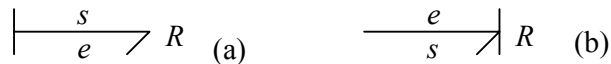
Figure B.1. Entrée e et sortie s d'un élément R en causalité résistance (a), en causalité conductance (b).
