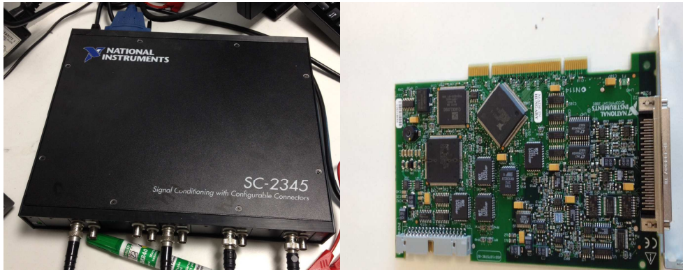
FIGURE 4.2 – La boîte de connexion des capteurs
