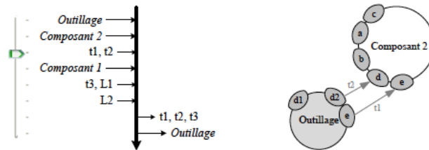
FIGURE 2.50 – Graphe de la première étape d'assemblage
