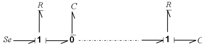
FIG. 2.19 – Modélisation de phénomène de diffusion dans une réaction chimique
