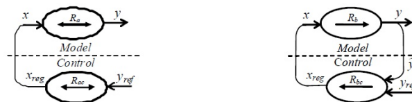
FIGURE 2.2 – Processeurs rigide (gauche) et causal (droite) et le contrôle associé en GIC [65]
