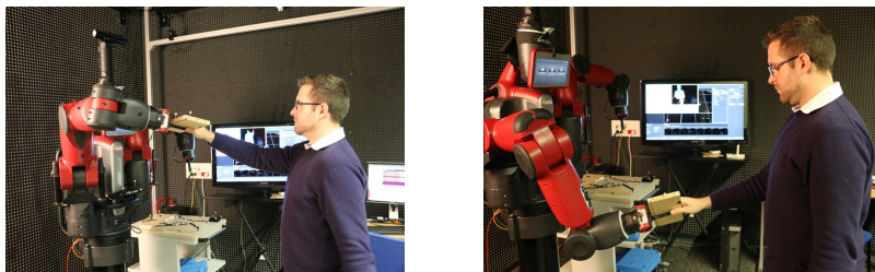
Figure 3: Différences entre deux types d'interaction. Une interaction ayant un impact négatif sur la santé de l'ouvrier (gauche) comparé à une interaction plus saine (droite)
