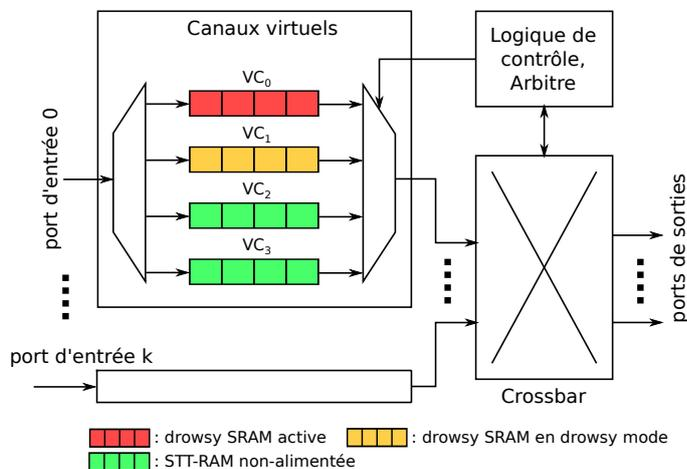
FIGURE 3.6 – Disposition hiérarchique de la mémoire hybride.  $VC_0$  et  $VC_1$  sont les mémoires drowsy SRAM et  $VC_2$  et  $VC_3$  sont les STT-RAM.
