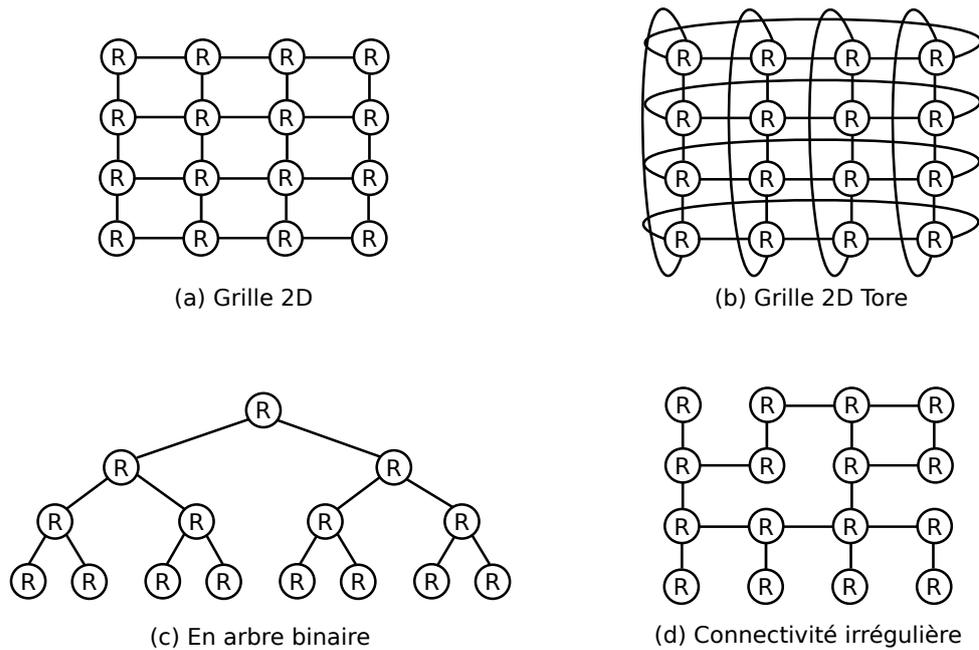
FIGURE 1.2 – Différents exemples de topologies de NoC.
