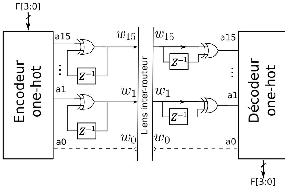
FIGURE 4.13 – Encodeur CIC avec les détails au niveau porte logique du générateur et détecteur de front.
