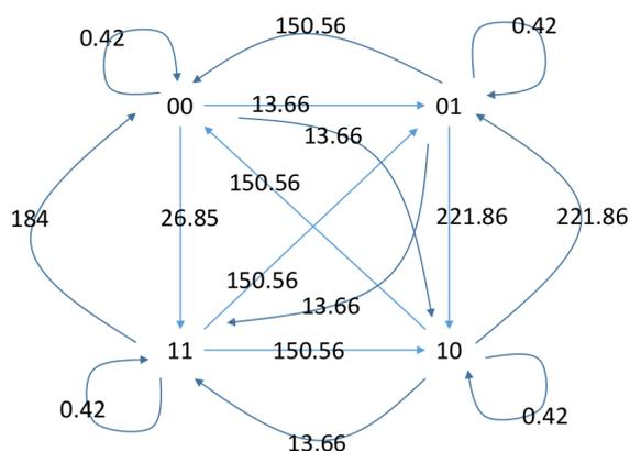
FIGURE 4.4 – Représentation du coût énergétique (en fJ) de chaque transition pour des mots de données de taille  $N = 2$ . Les sommets représentent les mots et les arêtes sont les transitions avec le coût énergétique indiqué.
