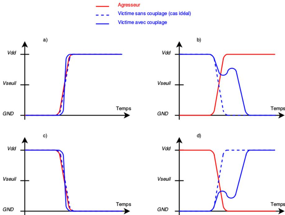
FIGURE 2.4 – Retards potentiels sur le fil victime (avec transition) [23].
