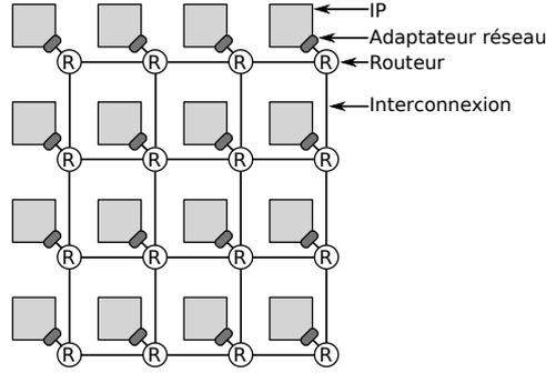
FIGURE 1.1 – Schéma classique d'un NoC mesh-2D (grille 2D).
