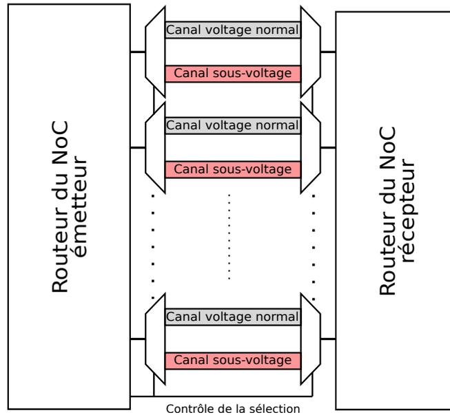
FIGURE 3.11 – Schéma d'implantation du système de transmission au voltage variable.
