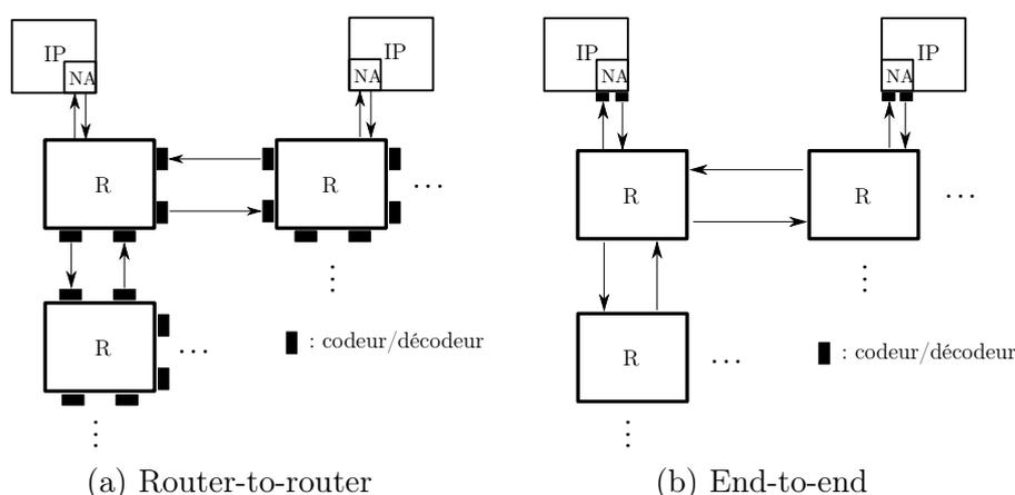
FIGURE 3.10 – Position des codecs en Router-to-router et end-to-end.
