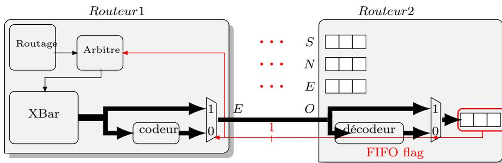
FIGURE 4.17 – Stratégie occupation des buffers (OCC). La sortie Est du *Routeur1* est contrôlée selon l’occupation des buffers de l’entrée Ouest du *Routeur2*. Les signaux de FIFO des entrées restantes sont connectées aux autres routeurs voisins du *Routeur2*.
