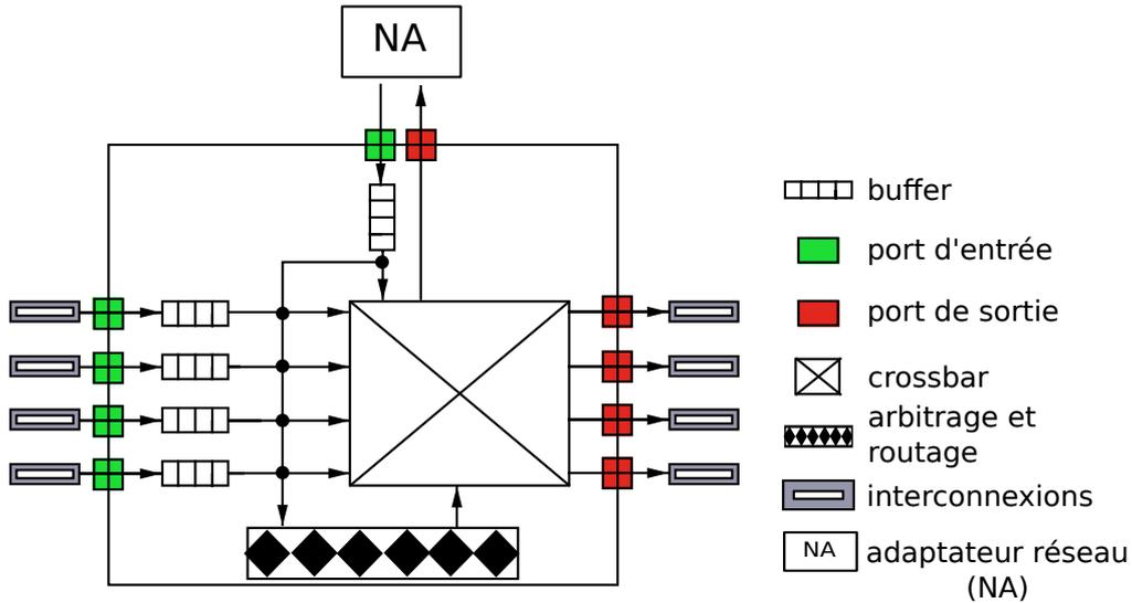
FIGURE 1.7 – Détail des composants d'un routeur avec buffers en entrée. Les interconnexions inter-routeurs et le NA sont également représentés.
