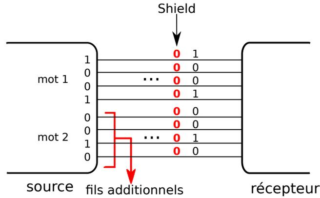
FIGURE 4.1 – Shielding Temporel [86] sur les bus. La taille originale du bus est de 4 bits.
