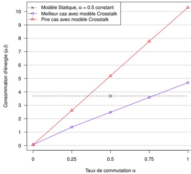
FIGURE 2.14 – Consommation d'énergie des liens avec le modèle Statique et crosstalk sous différentes valeurs de  $\alpha$  avec  $\text{pir} = 0.017$ .  $\alpha$  étant calculé selon les données des flits pendant les simulations.
