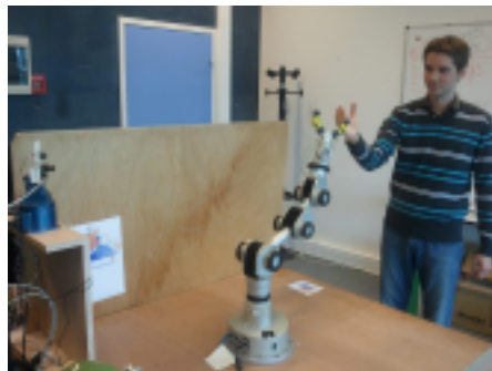
FIGURE 2.15 – Système expérimental constitué d'un bras Katana dont on utilise 4 DOF, d'une caméra 640x480, et d'une personne interagissante.
